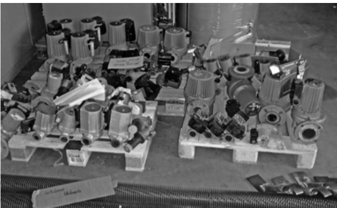
Die Gemeinde tauscht in den Ferien in ihren Hallen und Schulen und sonstigen öffentlichen Einrichtungen die alten Energie fressenden Umwälzpumpen aus. Damit können die Stromkosten erheblich gesenkt werden, und die Gemeinde leistet damit einen wichtigen Beitrag zur CO 2 -Einsparung.
