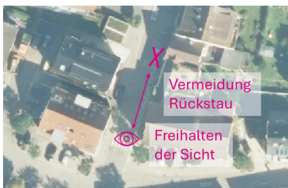
Abbildung 25: Skizze der freigehaltenen Querungsstelle durch Entfall des nördlichen Parkstands
